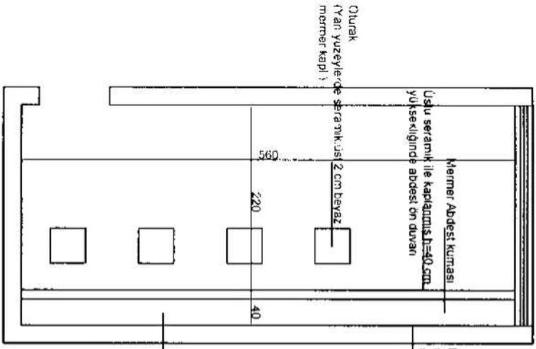
h=120 cm duvarda sıva sökümü sonrası elastomerik reçne ile yalıtım sonrası beyaz duvar seramik kaplı
